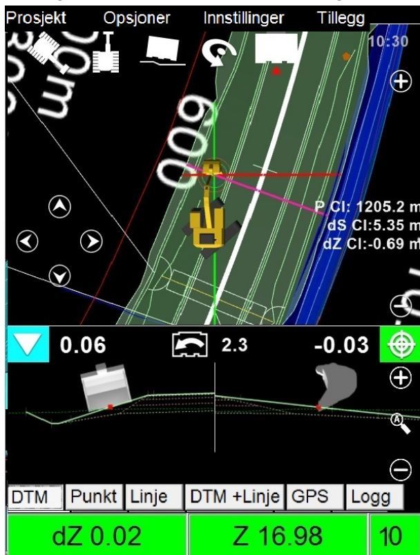
Figur. 59. Hovedvisning av LandNova med profil og tverrseksjoner
