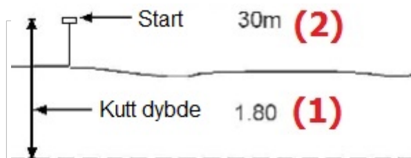
Figur. 16. Start- og kuttedybde på et anleggssted
